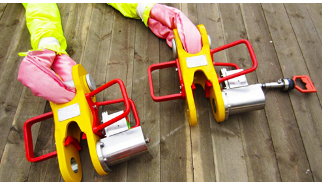
Figura 5: Primeira manilha hidráulica à base de água do mundo.
