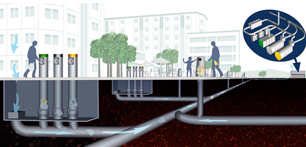
Figura 24: Esquema do sistema automático de coleta de lixo (AWCS).
