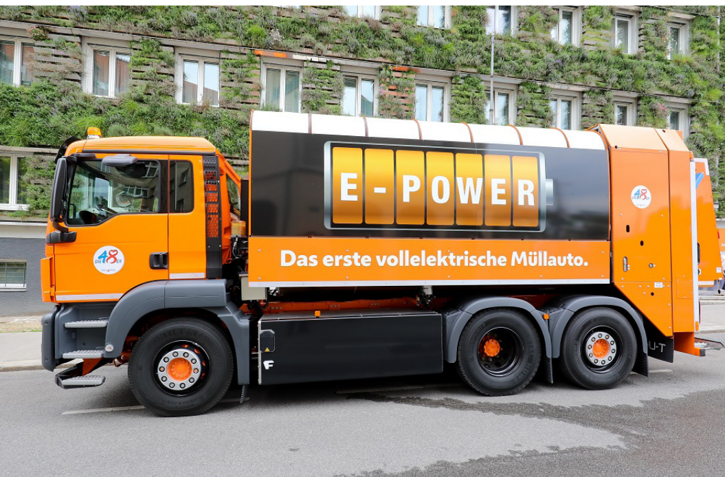
Figura 44: Primeiro veículo elétrico de coleta de lixo da Áustria.
