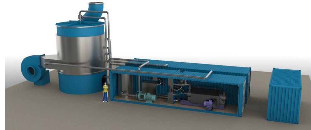
Figura 42: Tecnologia 3C para redução das plantas de captura de carbono.
