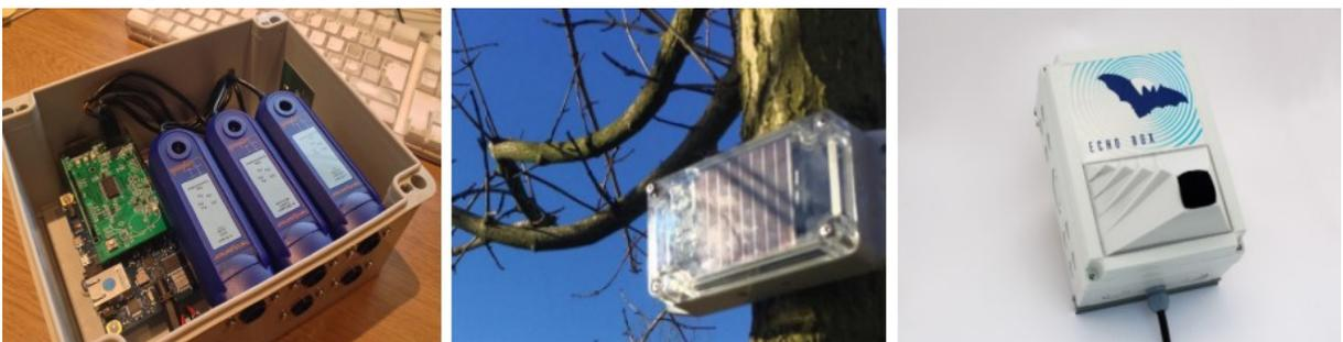
Figura 1 - Sensor de qualidade do ar (esquerda), monitor de microclima (centro) e sensor de morcegos (direita). Fonte: Jackson *et al.* (2017).
