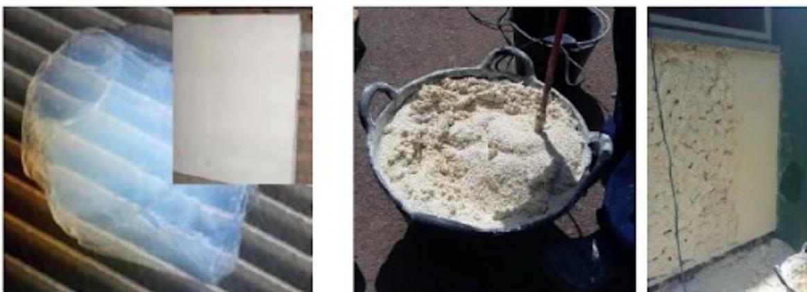
Figura 4 - Argamassa à base de aerogel. Fonte: Ahmed, Mateo, Garcia (2017).
